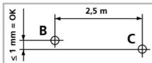
Sie, ob die waagerechte Linie von Punkt C  $\pm 1$  mm auf der gleichen Höhe mit dem Punkt B liegt. Vorgang durch Schwenken nach links wiederholen.
