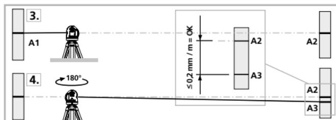
! Jos A2 ja A3 ovat toisistaan etäämällä kuin  $0,2 \text{ mm} / \text{m}$ , on säätö tarpeen. Ota yhteys paikalliseen laitetoimittajaan tai UMAREX-LASERLINER huolto-osastoon.
