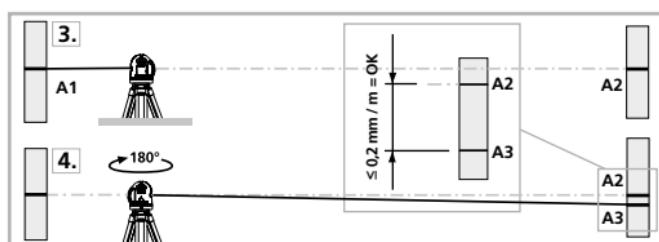
! Si A2 y A3 se encuentran a más de 0,2 mm / m entre sí, será necesaria un ajuste. Póngase en contacto con su distribuidor especializado o diríjase al Servicio Técnico de UMAREX-LASERLINER.
