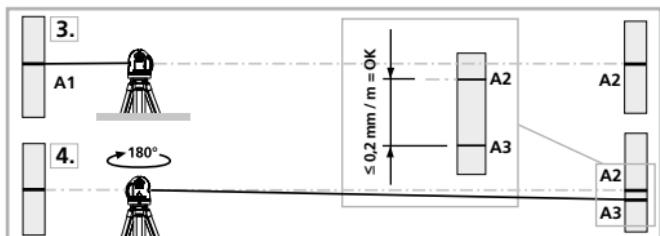
! Wanneer het verschil tussen punt A2 en A3 groter is dan de aangegeven tolerantie, nl.  $0,2 \text{ mm} / \text{m}$ , is een kalibratie nodig. Neem hiervoor contact op met uw vakhandelaar of met de serviceafdeling van UMAREX-LASERLINER.
